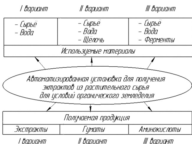
Рисунок 6 – Функционал разрабатываемой установки для получения экстрактов из растительного сырья
