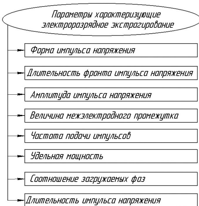
Рисунок 5 – Параметры, характеризующие электроразрядное экстрагирование
