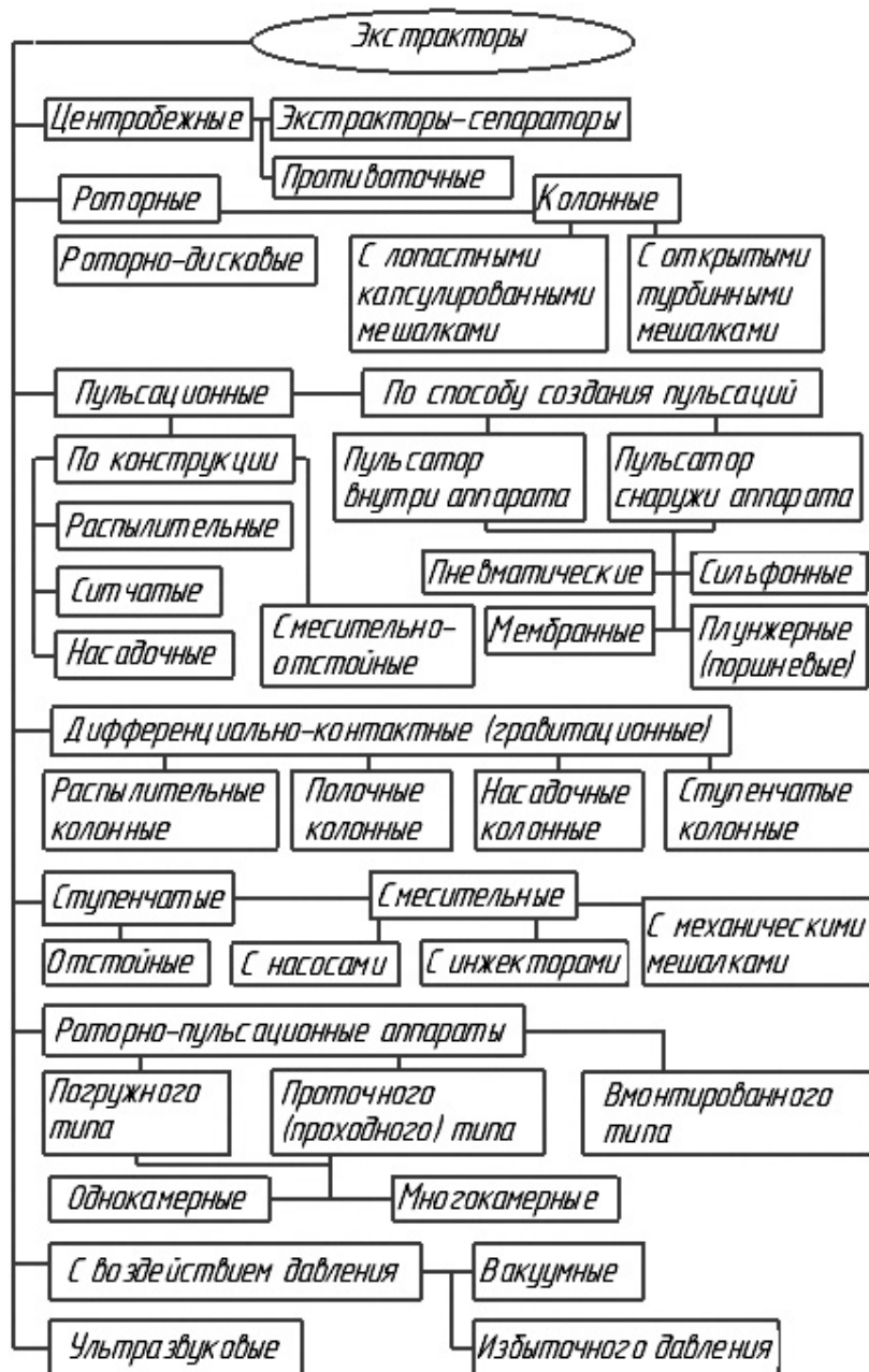
Рисунок 2 – Классификация экстракторов по конструктивным особенностям
